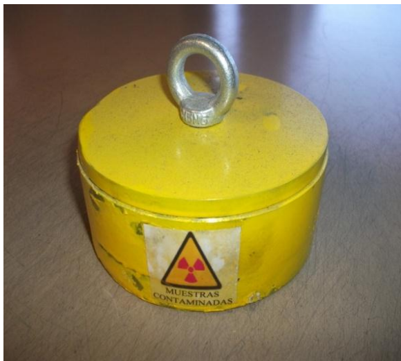
Figura 7. Blindaje necesario en caso de detectar radiación en la probeta.
