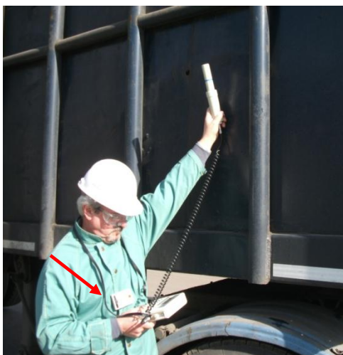
Figura 9. Empleo de dosímetro personal en el monitoreo de la carga de un vehículo.
