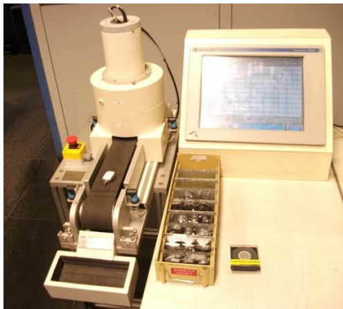
Figura 5. Espectrómetro gamma, utilizado para análisis de probetas de colada y escoria
