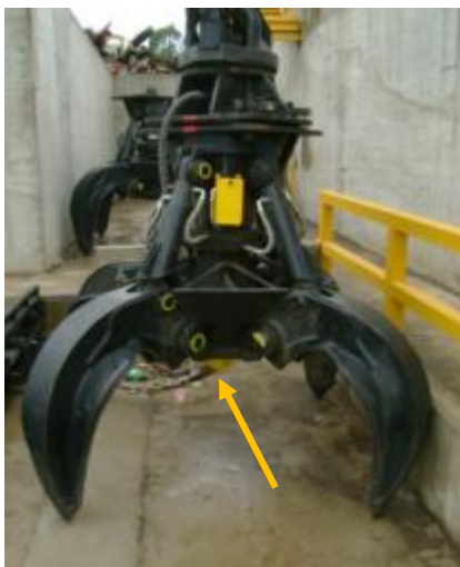
Figura 3. Detector instalado en grúa y sistema de transmisión remota (pulpo).
