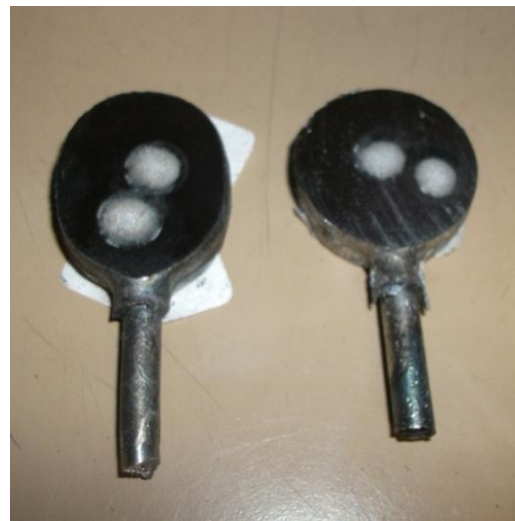
Figura 8. Modelos de probetas extraídas de la colada.
